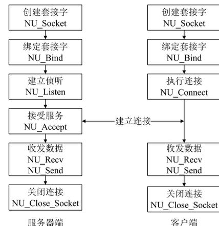
图2 TCP协议通信流程图
