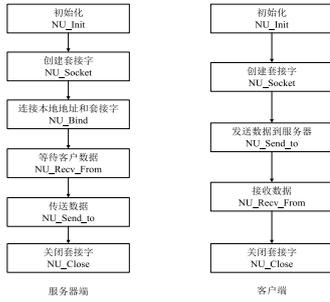
图3 UDP协议通信流程
