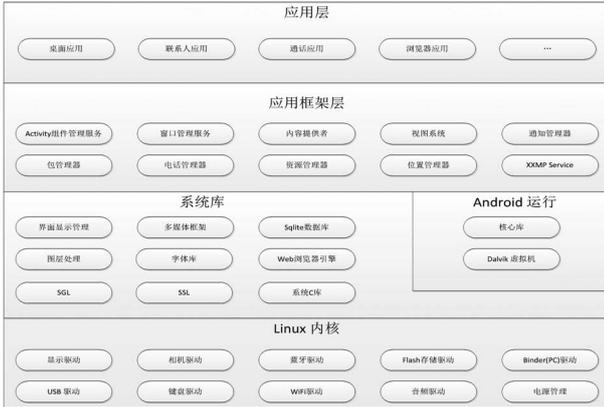
图1 Android系统架构图
