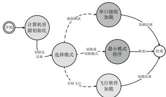
图4 启动加载软件工作模式
