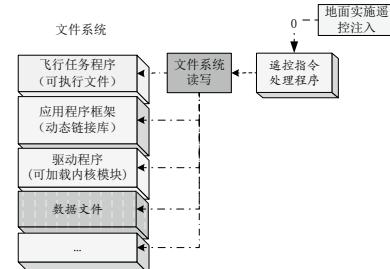
图7 基于操作系统的软件在轨重构示意图
