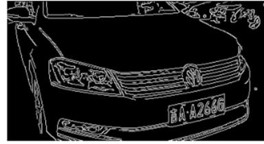
图3 Canny算子边缘检测结果
