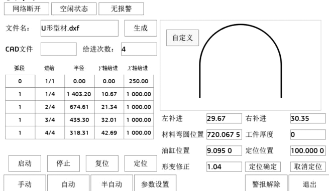
图 8 数控三轴弯圆机人机交互系统界面
